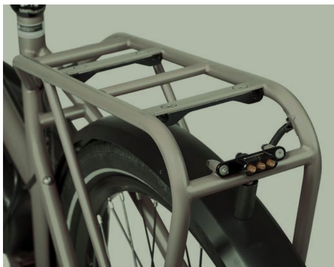
Im Rahmen integrierter Gepäckträger aus CrMoly mit modularer Aufnahme des Snap-IT® Systemgepäckträgers von Racktime®
