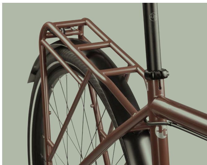
^ Schmaler integrierter Touren-Gepäckträger aus rostfreiem Edelstahl mit zweiter Strebe für tiefen Gepäckschwerpunkt; doppelt so steif wie ein geschraubter CrMo-Gepäckträger
