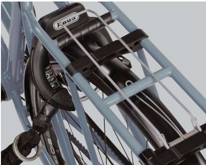
Integrierte Rahmen-Schlossbefestigung mit optionaler Kette. Die modulare Edelstahl-Federklappe ist als Option verfügbar.
